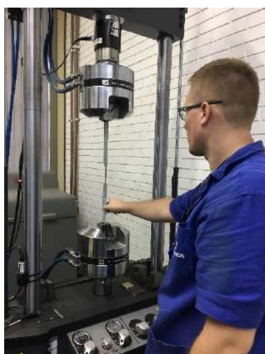
(a) Instalação do corpo de prova
