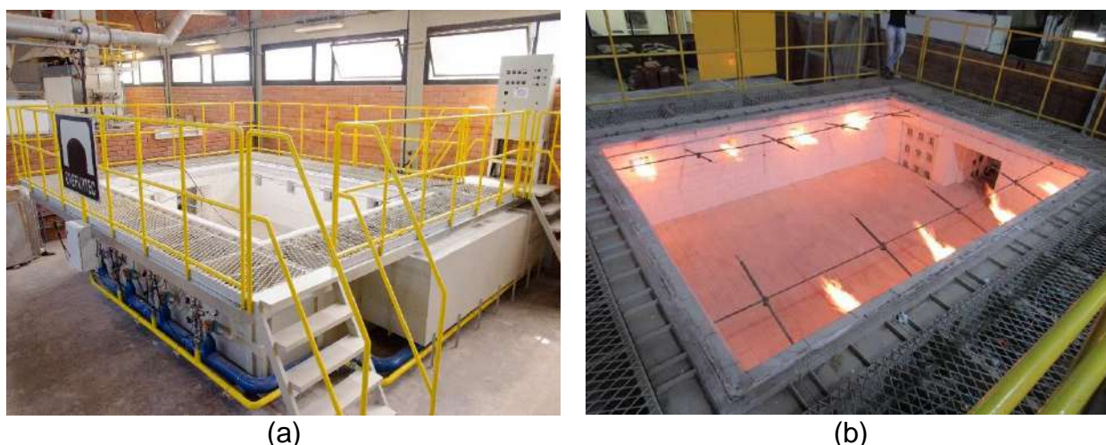
Figura 59 – Forno horizontal empregado nos ensaios de resistência ao fogo
