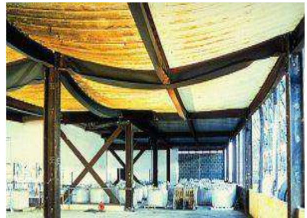
(b) Deflexões desenvolvidas em lajes mistas em laboratório: o caso do ensaio de Cardigton
