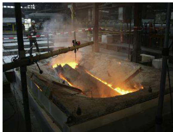
(b) Colapso da laje ao término do ensaio
