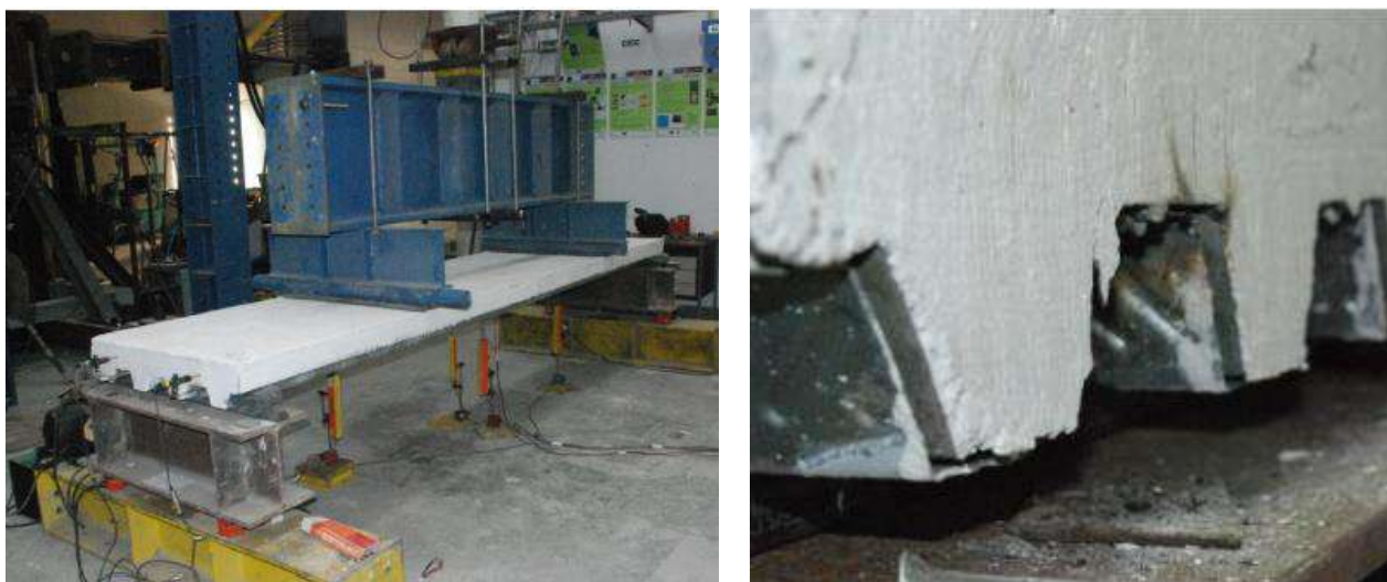
(a) Configuração do ensaio experimental (b) escorregamento relativo chapa-concreto
