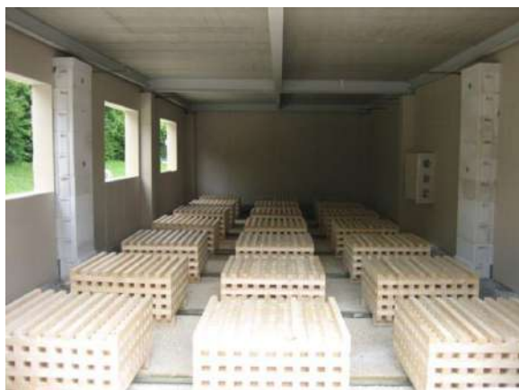
(c) Carga de incêndio para a simulação
