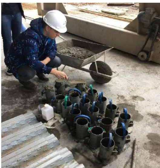
Figura 220 – Moldagem dos corpos de prova
