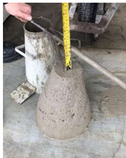
Figura 221 – Procedimento do ensaio de abatimento do concreto
