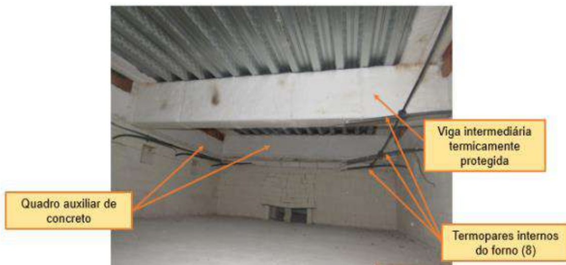
Figura 53 – Vista interna do forno vertical, com a laje posicionada para ensaio
