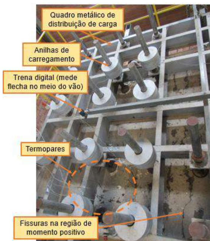
Figura 79 – Fissura na região de momento positivo
