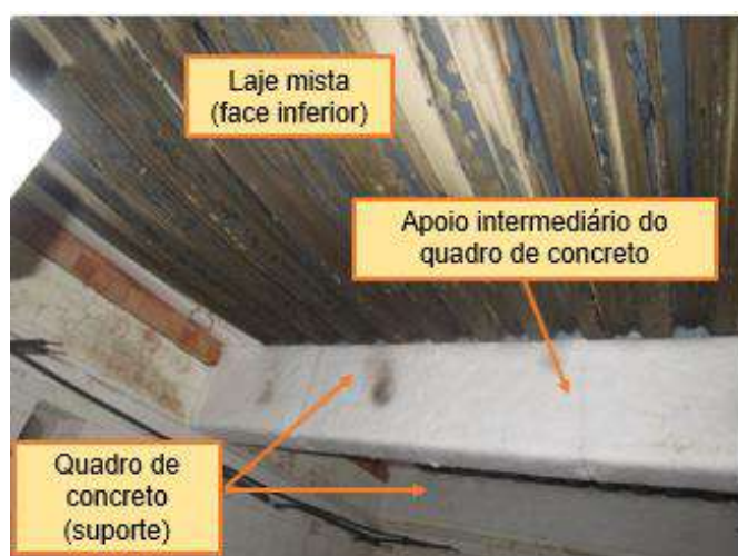
Figura 86 – Vista inferior da laje, após ensaio
