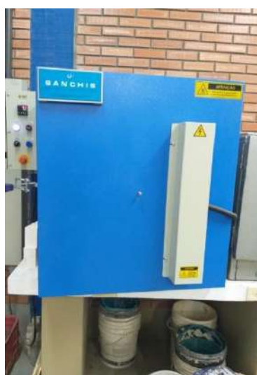
(a) Vista geral da mufla elétrica
