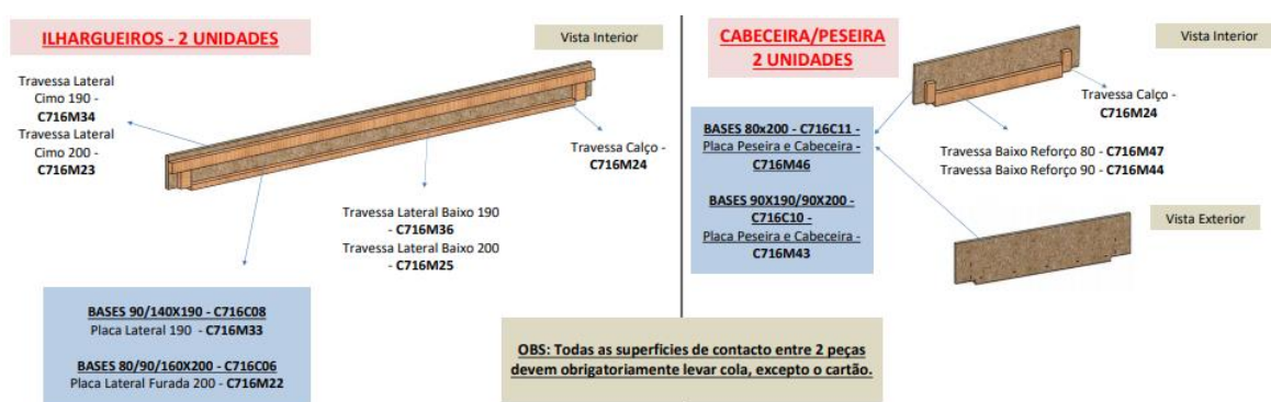
Figura 4. Constituição das componentes produzidas na pré-montagem (Fonte: Fichas Técnicas Bases 716)
