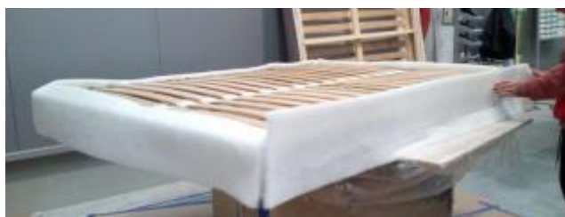
Figura 7. Processo de colagem de fibra de uma base 716 (Fonte: Fichas Técnicas Bases 716)
