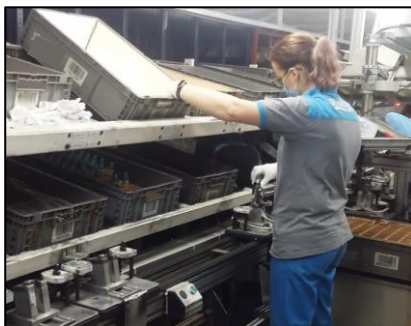
Figura 12 – Operador a montar a torneira.
