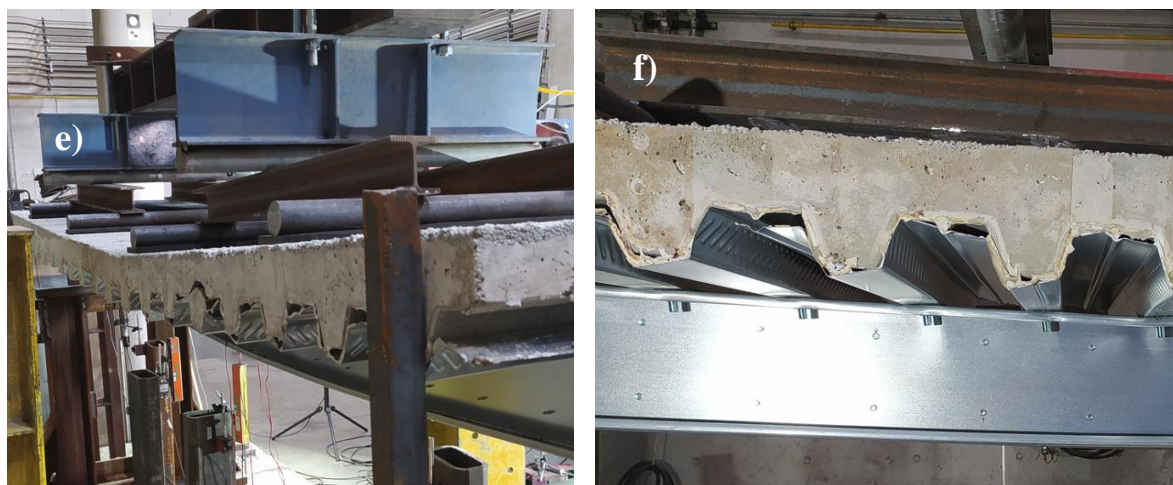
Figura 5.17 – a) Fissuração no betão, b) Deformada quando que formam fissuras no betão, c) Esmagamento do banzo superior e alma, d) Plastificação do aço, zona de estrição, e) Deformação final, f) Efeito do esforço de corte
