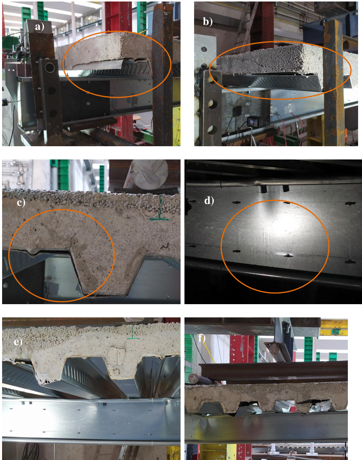
Figura 5.13 – a) e b) Separação do betão da chapa nas extremidades, c) Fissuras devido a esforço transversal, d) Plastificação do aço (Zona de estrição), e) e f) Separação do betão da chapa a meio vão. Corte longitudinal e esmagamento do banzo superior e alma.
