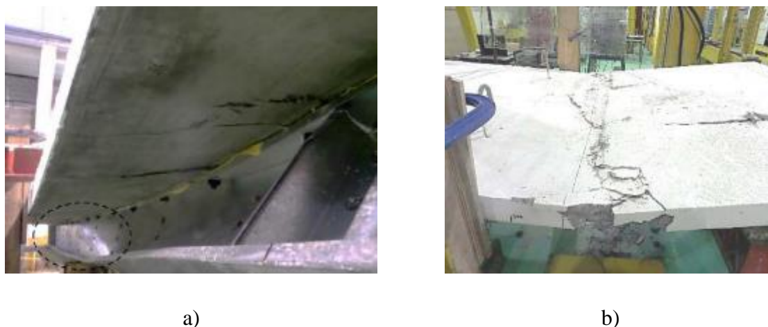
Figura 2.4 – a) Encurvadura por esforço transverso, b) Esmagamento do betão (M. M. Lawan et al,2020)
