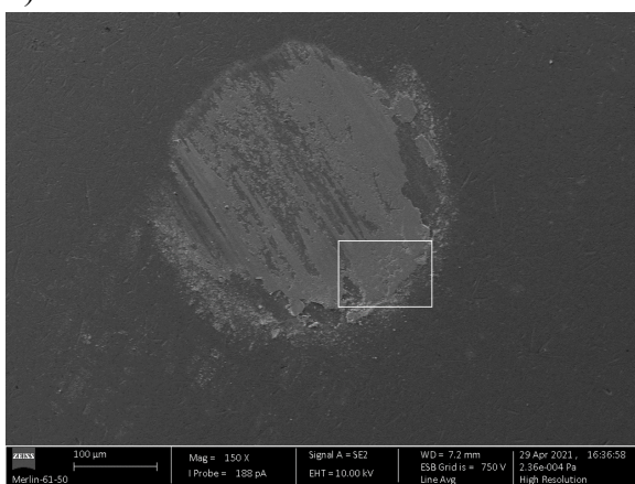
Figura 4.14. Imagens SEM das camadas de transferência formadas nas esferas de aço após os ensaios PD com os revestimentos DLC-W a 100 °C, com duração de 11 300 segundos. A área retangular correspondente ao retângulo branco foi ampliada e as composições químicas das zonas 1 e 2 foram analisadas por EDS: a) Análise SEM-EDS ( r_e = 18 mm), b) Análise SEM-EDS ( r_e = 16 mm).
