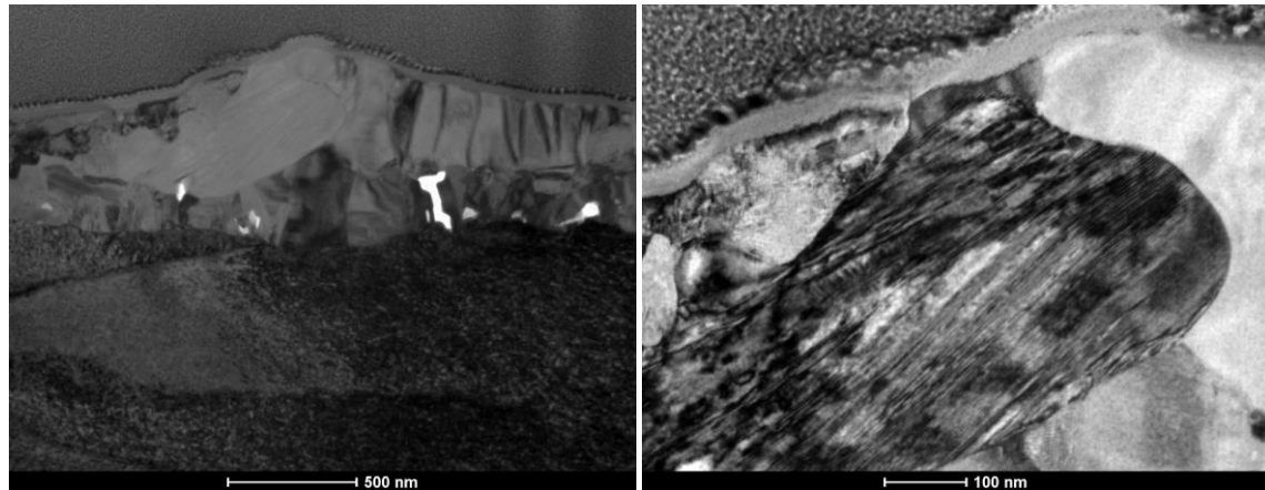
Figura 3.22. Imagens TEM BF do filme multicamada Al/Ni_0,2_12_II após ignição.
