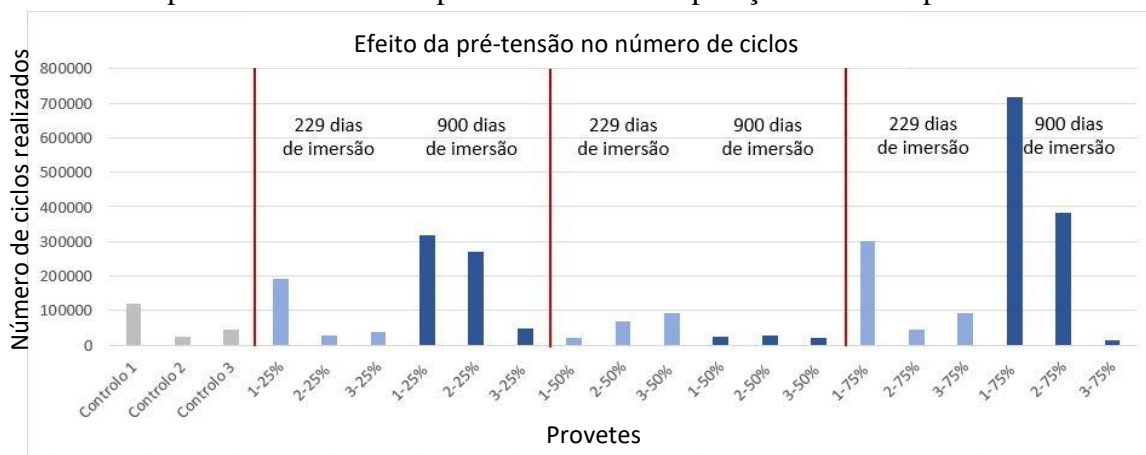
Figura 4.2 - Valores de vida à fadiga, em ciclos, dos provetes pré-tensionados.
