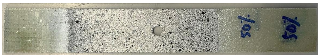
Figura 3.2 – Provete de resina epoxídica reforçado com fibra de vidro com padrão speckle .
