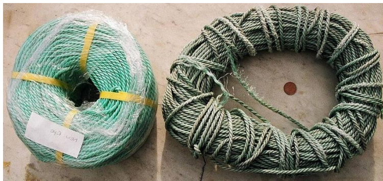
Figura 2.3 – Efeitos da foto-oxidação numa corda de polímeros- https://pt.wikipedia.org/wiki/Foto-oxidação 2021.
