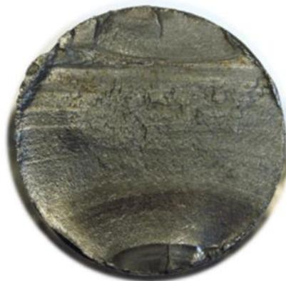
**Figura 1. Superfície de fratura por falha de fadiga**
