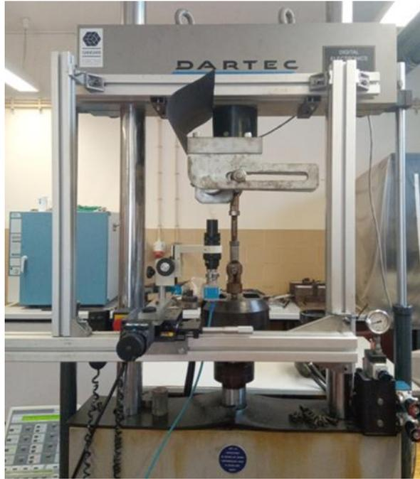
Figura 10. Máquina servo hidráulica DARTEC usada nos ensaios de fadiga.
