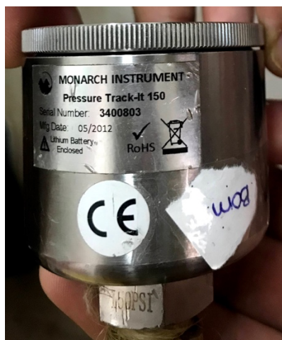
Figura 3.4 – Fotografia do equipamento de medição de pressão que se instalou.
