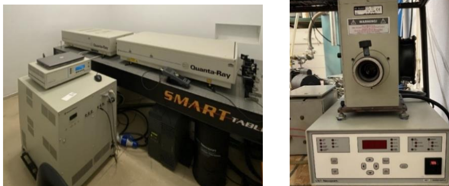
Figura 2.7 - Equipamento utilizado nas experiências de irradiação das matrizes criogénicas: Laser e oscilador paramétrico ótico, à esquerda; lâmpada de Hg(Xe) à direita, com as respetivas fontes de alimentação e sistemas de controlo.
