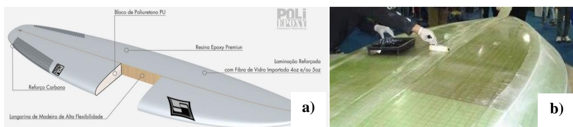
Figura 2.3. Aplicações de laminados vidro/epóxico; a) prancha de surf; b) casco de barco.
