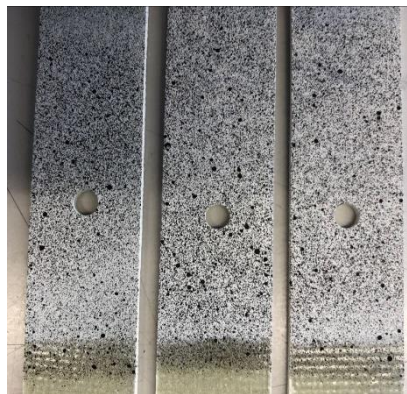
Figura 3.7. Amostras após pintura, com padrão speckle .
