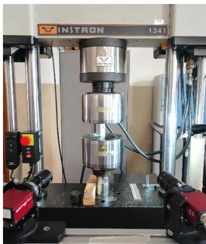
Figura 3.6. Máquina servo-hidráulica INSTRON 134 com as câmaras do software VIC-3D incorporadas.
