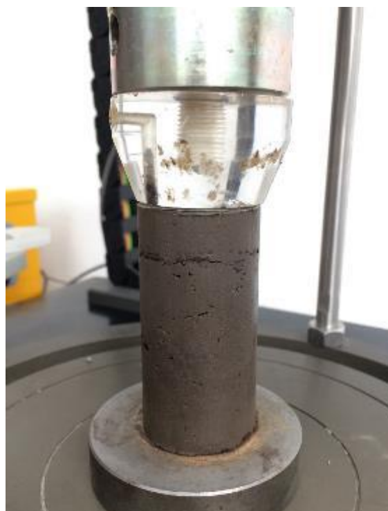
Figura 4.10 - Amostra com 5,5%OM + Xantano pronta para ser ensaiada.
