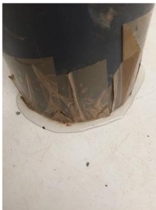
Figura 4.6 - Segregação de água após carregamento.
