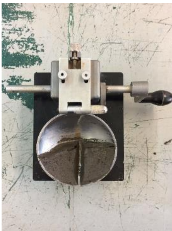
Figura 3.4 - Determinação do w_l a partir da Concha de Casagrande.
