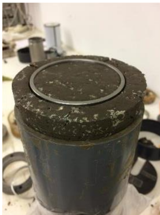
Figura 4.15 - Cravação do anel edométrico na amostra 5,5%OM + Xantano.
