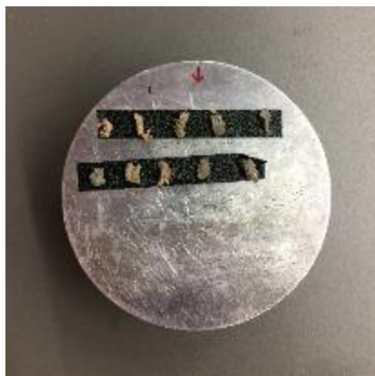
Figura 4.20 - Amostras utilizadas para Imagens SEM, com e sem Xantano para os diferentes teores em matéria orgânica.
