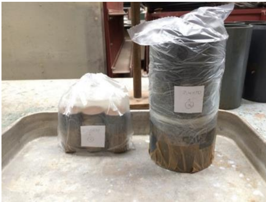
Figura 4.7 - Amostras com 2,4%OM + Xantano preparadas para cura de 14 dias na câmara termo-higrométrica do laboratório.
