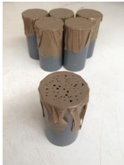
Figura 4.4 - Tubos PVC 76/38 preparados.
