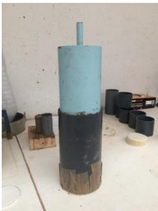
Figura 4.5 - Carregamento das amostras para os ensaios edométricos.
