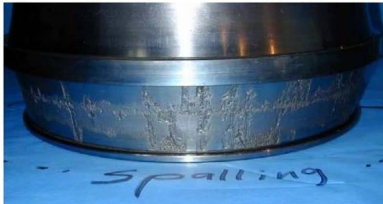
**Figura 10** Aspeto visual do *spalling*
