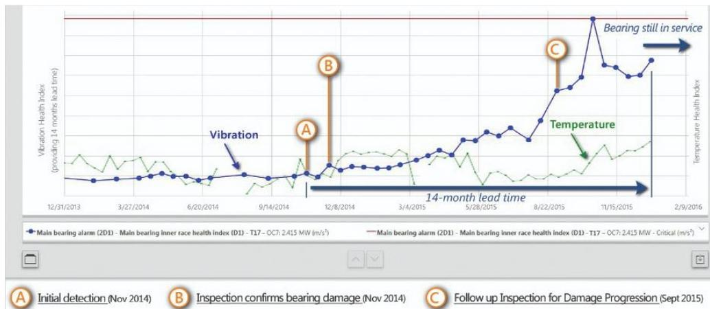
**Figura 17** Exemplo de detecção de falha por vibração com alerta de 14 meses de antecedência
