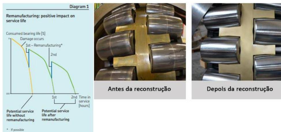
**Figura 22** Extensão potencial do tempo de serviço com a reconstrução e o aspeto visual da intervenção
