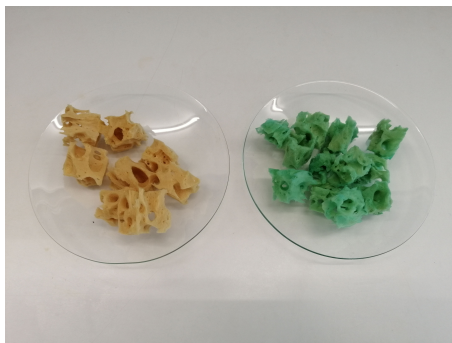
Figura 6.11: Suportes de esponjina pré (esquerda) e pós (direita) imobilização (ESP_B).
