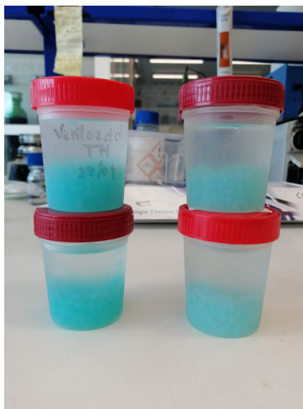
Figura 6.31: Fotocatalisadores posteriormente aos ensaios de 11/09 com pH inalterado (esquerda) e alcalino (direita).
