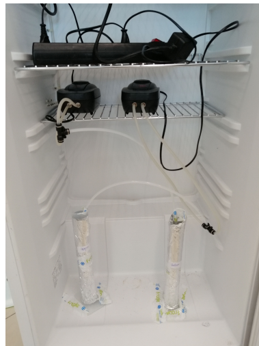
Figura 5.2: Configuração utilizada para os ensaios de adsorção realizados durante a presente dissertação
