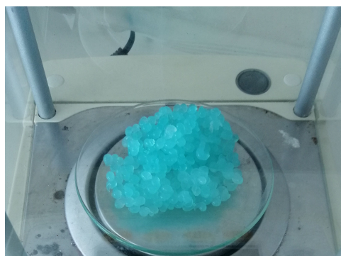
(b) Suportes à base de quitosano pós-imobilização (Fotocatalisadores de quitosano).
