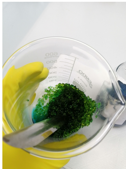
(b) Suportes à base de sílica pós-imobilização (Fotocatalisadores de sílica).
