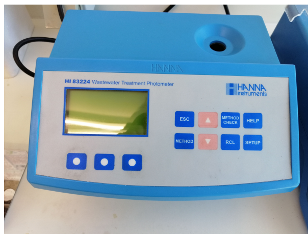
(b) Fotómetro HI 83224, HANNA Instruments.
