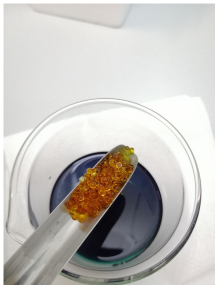
(a) Suportes à base de sílica pré-imobilização.
