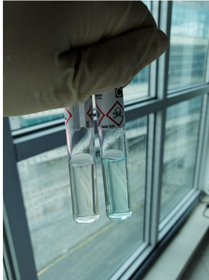
Figura 6.35: Amostras do efluente antes (esquerda) e depois (direita) do ensaio B5.
