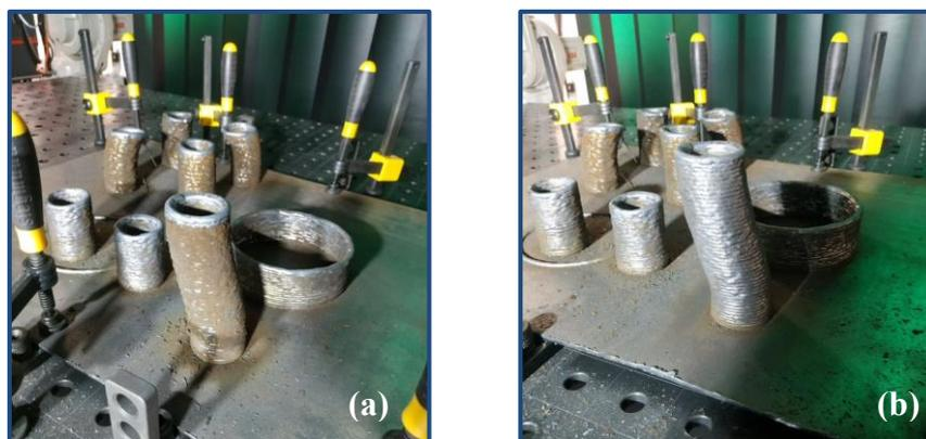
**Figura 4.5.** Cilindro (oco) inclinado: (a) peça segundos após o fim da impressão, e; (b) peça após limpeza da superfície.
