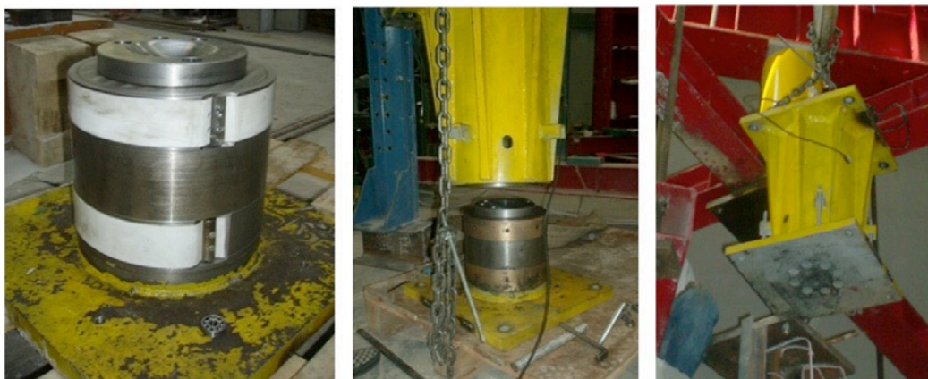
Figura 3.3 – Dispositivo para medir as forças geradas pela imposição da restrição. (Correia e Rodrigues, 2012)
