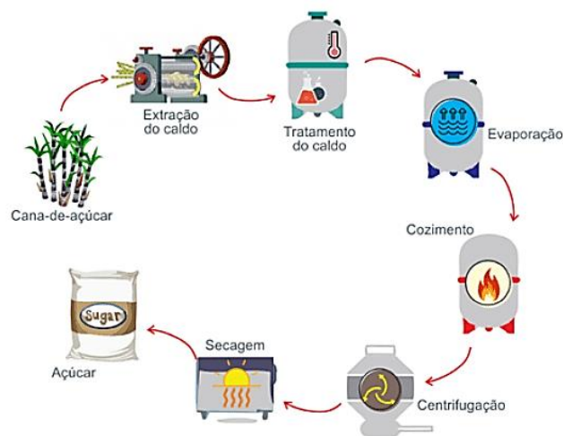
Figura 2.1. Esquema do processo de produção de açúcar.[8]
