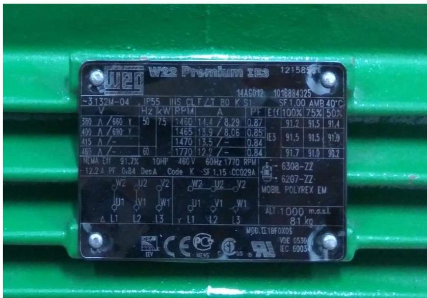
Figura A.1 – Chapa característica do MIT acoplado mecanicamente ao SPMSM de seis fases.
