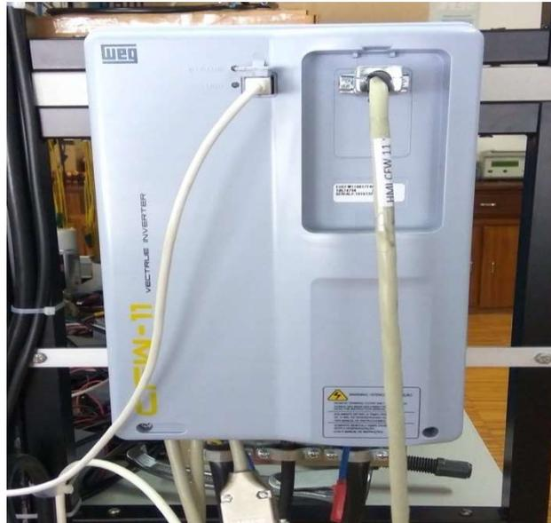
Figura C.5 – Variador eletrônico de velocidade utilizado para controlar o MIT.
