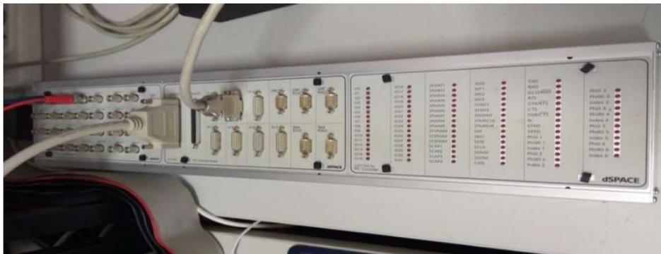
Figura C.9 – Painel de ligação de entradas e saídas da plataforma dSPACE DS1103.
