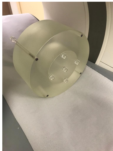
Figura 7: Fotografia que exemplifica a posição do fantoma na mesa da tomografia computadorizada alinhado com o centro da gantry.
