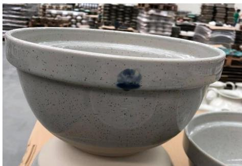
**Figura 7** - Peça contaminada com impressão digital
