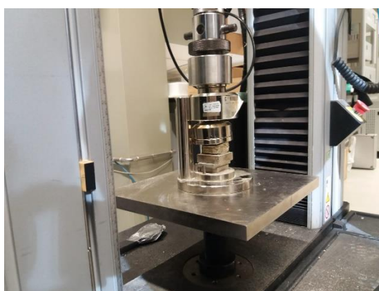
Figura 3.8 Ensaio da Resistência à Compressão
