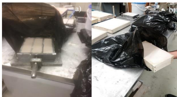
Figura 3.4 Cura das argamassas nos provetes e nos suportes
