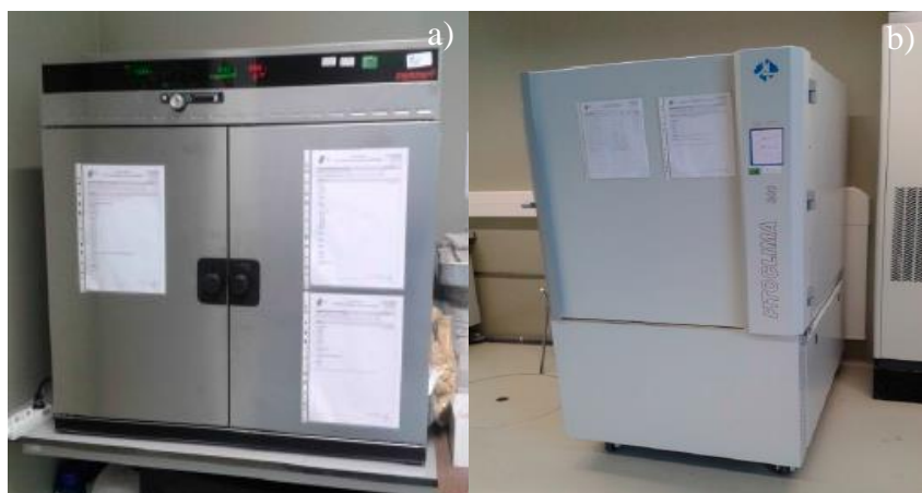
Figura 3.14 a) Camara de aquecimento b) Camara de congelamento
