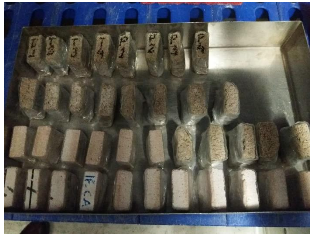
Figura 3.11 Impermeabilização dos provetes com papel filme
