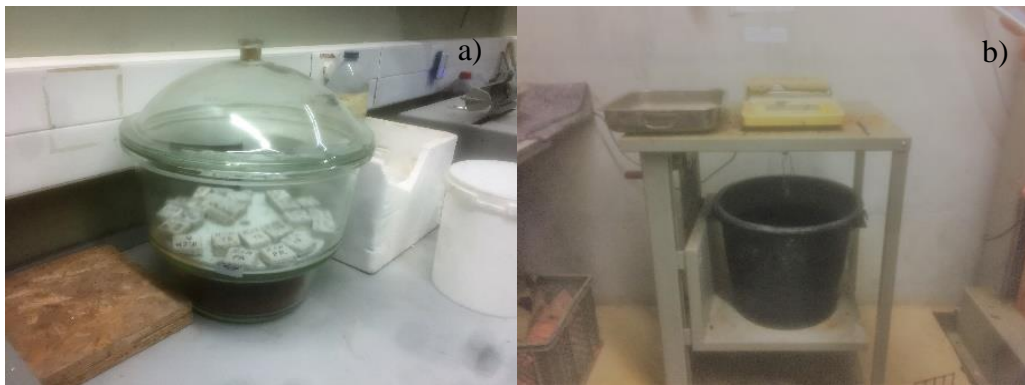
Figura 3.6 a) Provetes no Exsicador para o seu arrefecimento b) Pesagem Hidrostática
