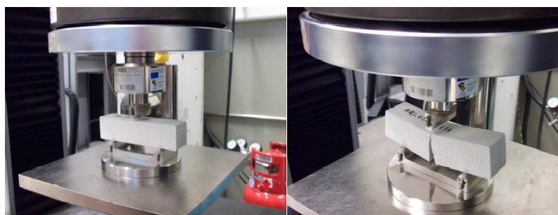
Figura 3.7 procedimento do ensaio da Resistência à Flexão
