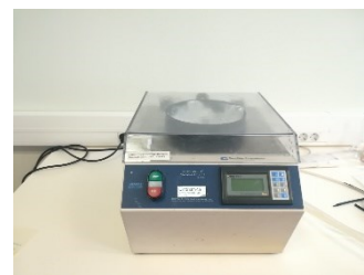
Figura 11: Fotografia do spincoater.
