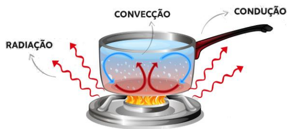
Figura 2-6 – Representação esquemática dos modos de transferência de calor
