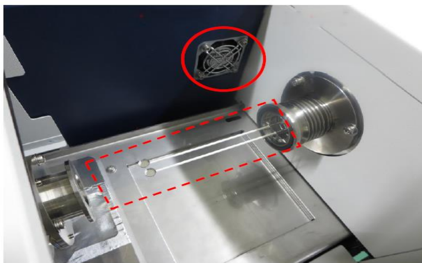
Figura 3.3 Representação esquemática do mecanismo da balança (Fonte: Nexta® STA200RV Manual)
