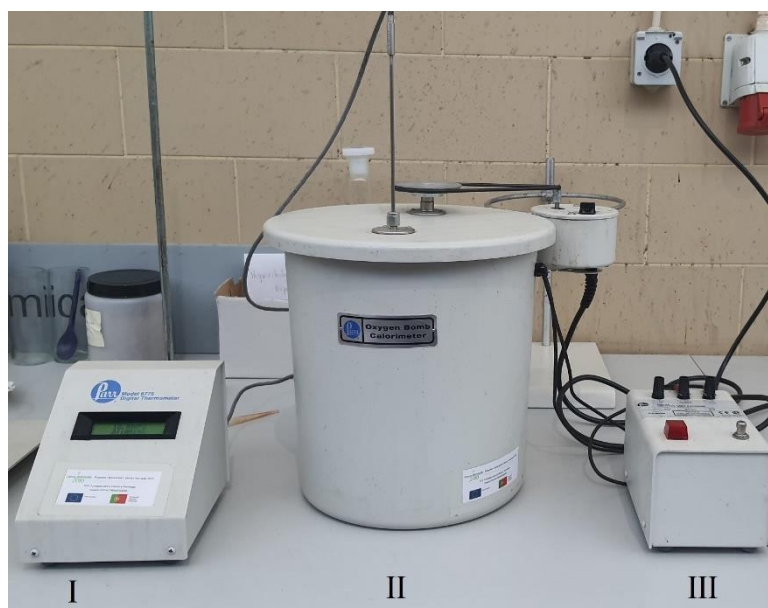
Figura 3.1 Equipamento utilizado na determinação do poder calorífico, I) leitor de tempo e temperatura; II) bomba calorimétrica; III) fonte de ignição
