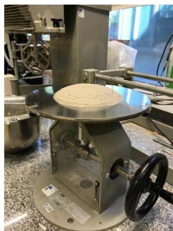
Figura 3.3 - Resultado final do ensaio de espalhamento da argamassa.
