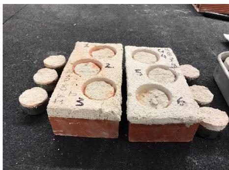
Figura 3.34 - Rotura coesiva na argamassa para tijolo maciço.
