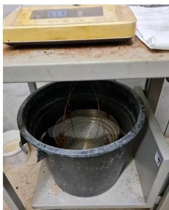
Figura 3.15 - Pesagem dos provetes em imersão.
