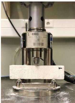
Figura 3.26 - Ensaio à tração por flexão na argamassa do molde prismático.
