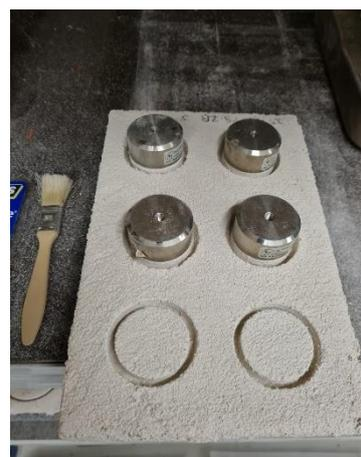
Figura 3.33 - Processo de colagem das chapas metálicas.
