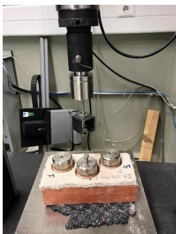
Figura 3.31 - Equipamento para aplicação da força de tração.
