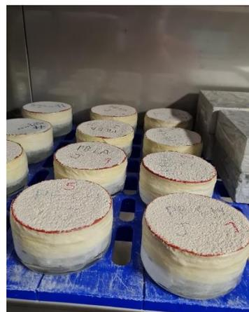
Figura 3.24 - Colocação de fita adesiva e parafina na lateral do conjunto.
