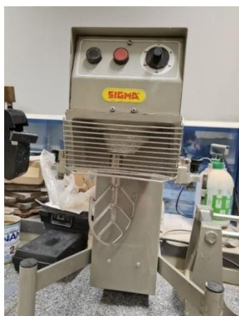
Figura 3.2 - Misturadora usada no ensaio de consistência por espalhamento.
