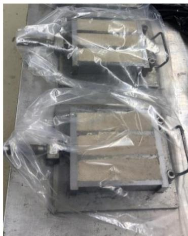
Figura 3.12 - Colocação dos provetes prismáticos (nos moldes metálicos) dentro de sacos de polietileno.
