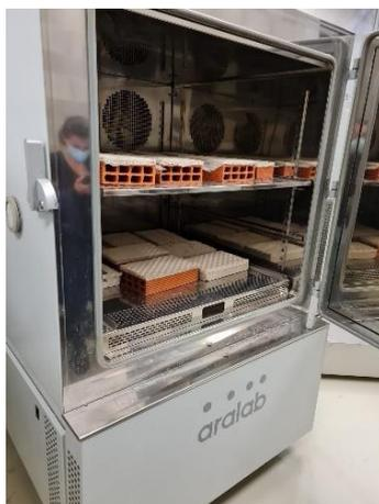
Figura 3.8 - Câmara climática aberta para pulverização dos provetes.
