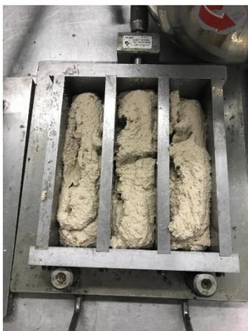
Figura 3.9 - Colocação da primeira camada de argamassa (não compactada).
