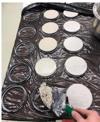
Figura 3.13 - Execução dos provetes circulares.
