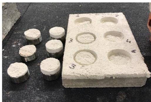
Figura 3.35- Rotura coesiva na argamassa e argamassa-cola para placa de betão.
