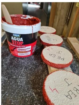
Figura 3.22 - Colocação de impermeabilizante na lateral do provete.
