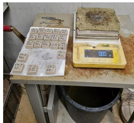
Figura 3.16 - Pesagem da massa saturada.
