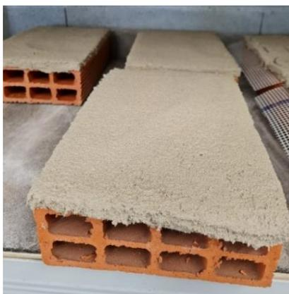
Figura 3.7 - Preparação do suporte de tijolo cerâmico furado, posteriormente sujeito ao ensaio *pull-off*.
