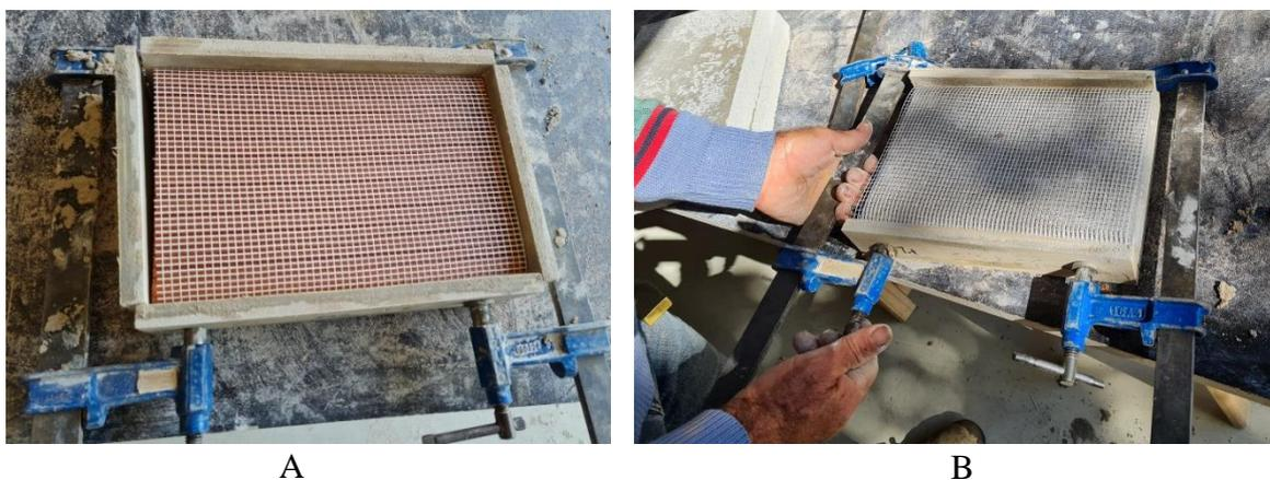
Figura 3.4 - Colocação dos moldes de madeira e respetivas redes de fibra de vidro em suporte de tijolo cerâmico furado (A) e placa de betão (B).
