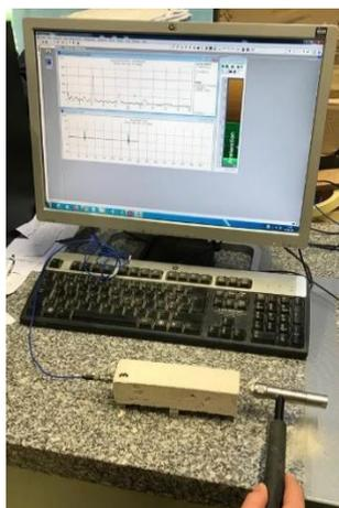
Figura 3.25 - Determinação do módulo de elasticidade dinâmico.
