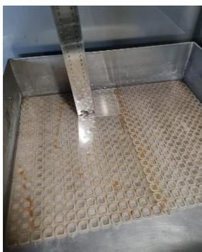
Figura 3.17 - Verificação da altura da água na tina metálica.
