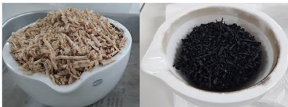
Figura 9 Matéria-Prima antes (esquerda) e após a pirólise (direita).
