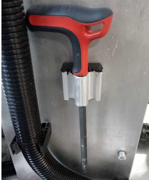
Figura 21. Criação de suporte para ter ferramenta junto de 1B.
