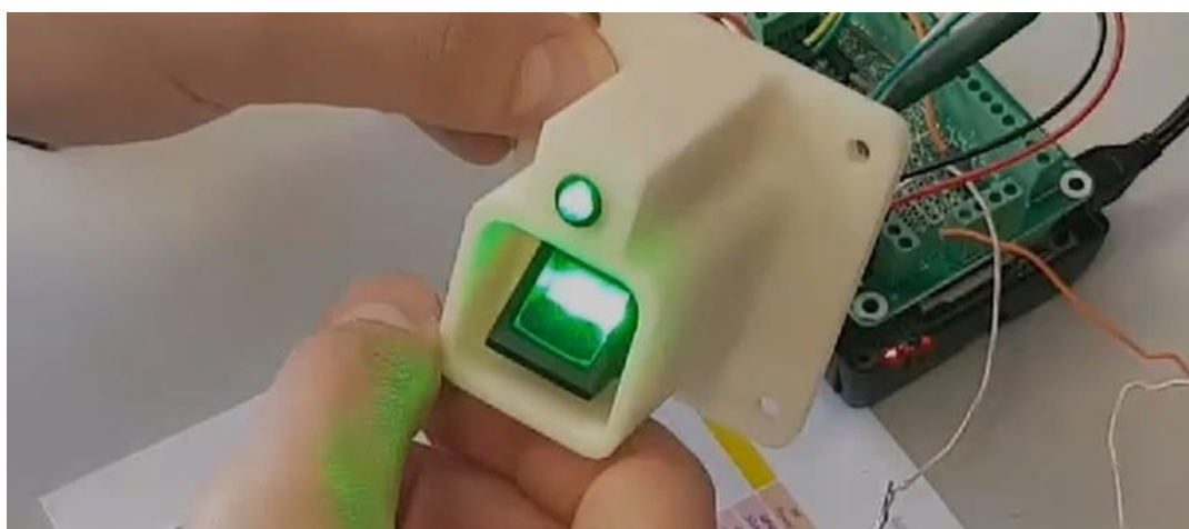
Figura 4.12. Protótipo do sistema de controlo de entradas e saídas de armazém.
