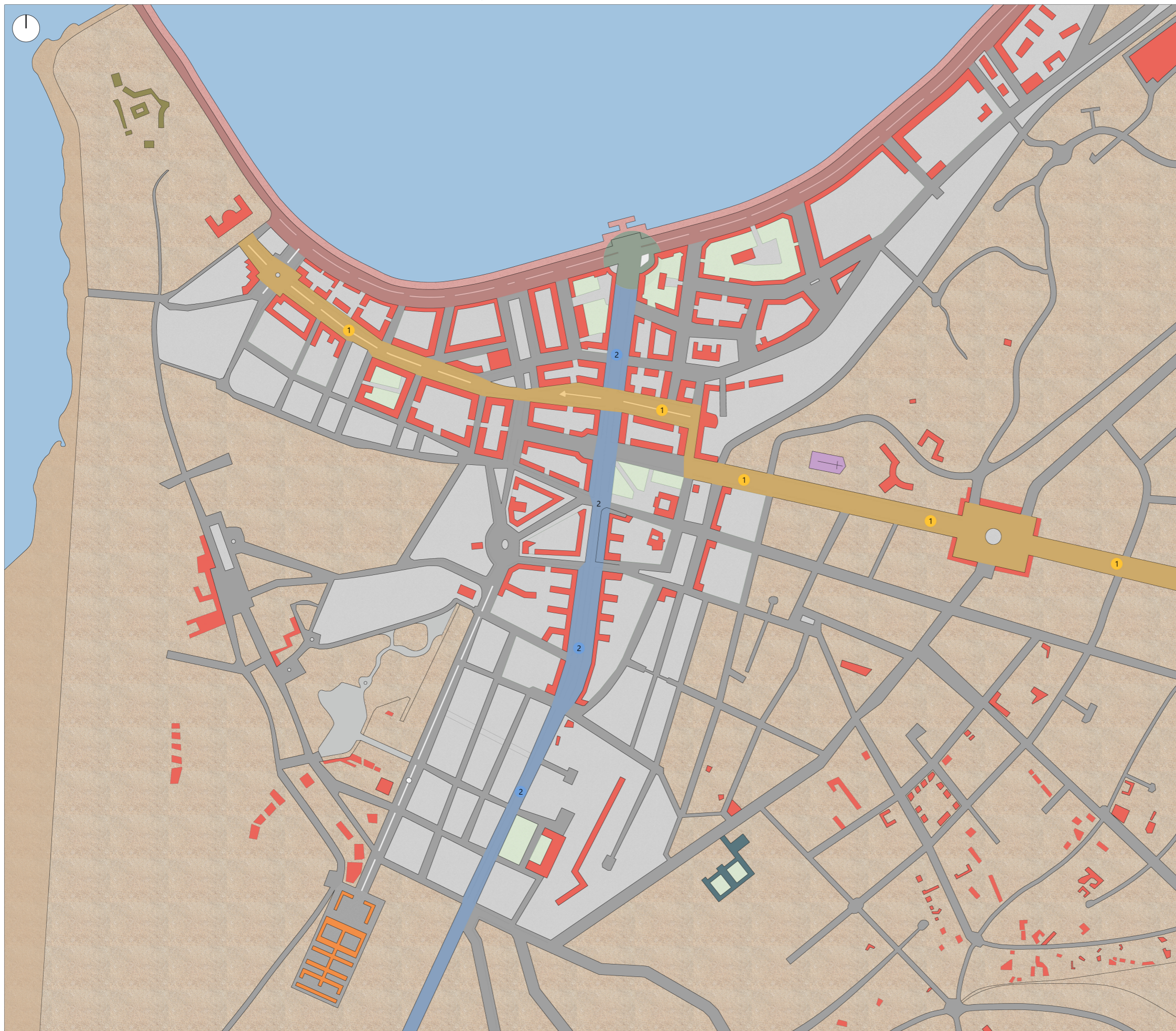
Fig. 51- Planta esquemática de infraestruturas feita através da interpretação do Plano de Urbanização de Luanda, aproximação da zona da baía de Luanda, autoria de Étienne de Gröer e David Moreira da Silva, escala 1:1000
