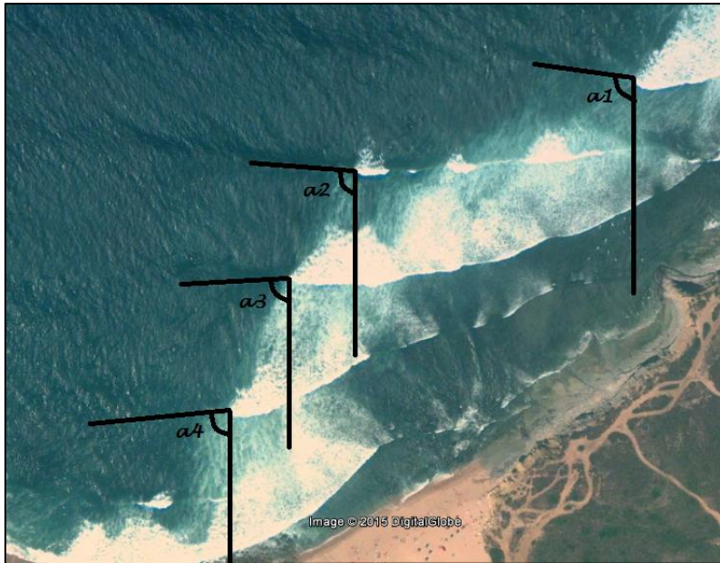
Figura 63 – Refração das ondas explícita através dos ângulos entre as ondas e uma linha de referência (Google Earth, 6/8/2009). Escala: 2,79cm/100m.
