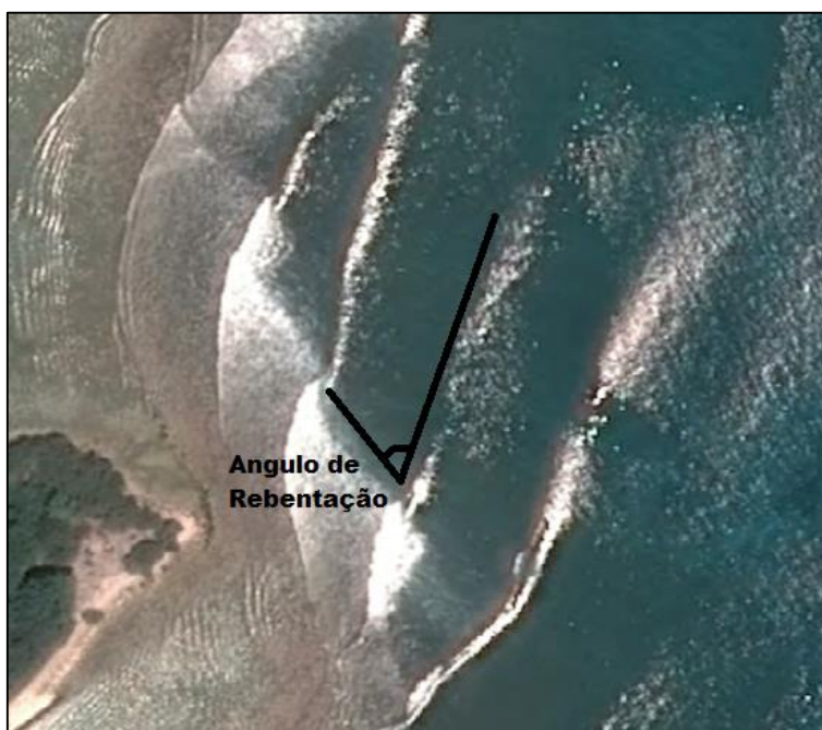
Figura 23- Representação de medição do ângulo de rebentação numa onda das Maldivas (Google Earth).
