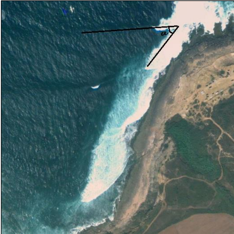
Figura 71- Ângulo de rebentação das ondas na Baía dos Coxos (6/8/2009, Google Earth). Escala: 2,52cm/100m.
