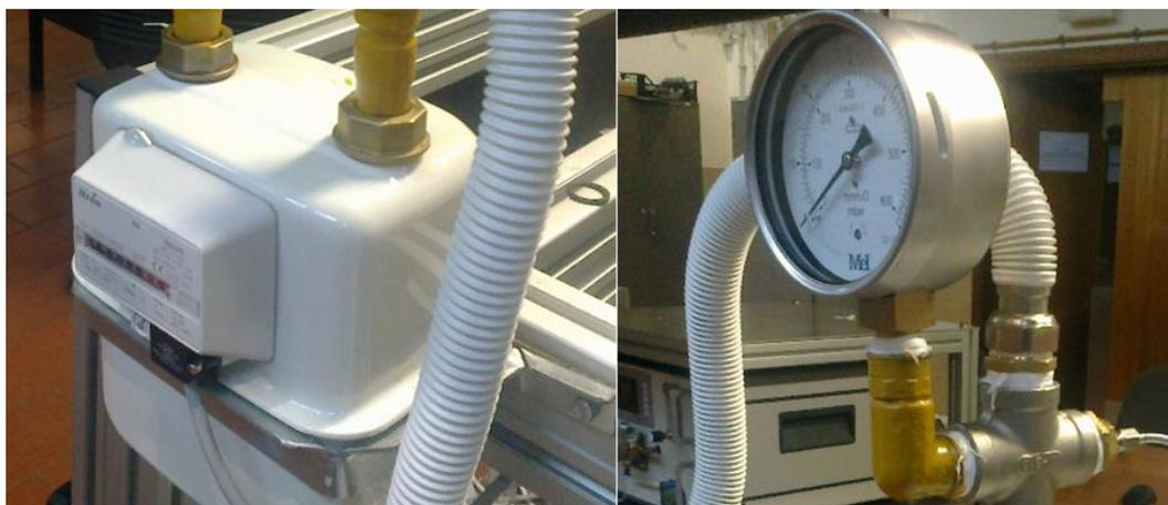
Figura 75 - Medidor de gás (esquerda) e manómetro de baixas pressões (direita)
