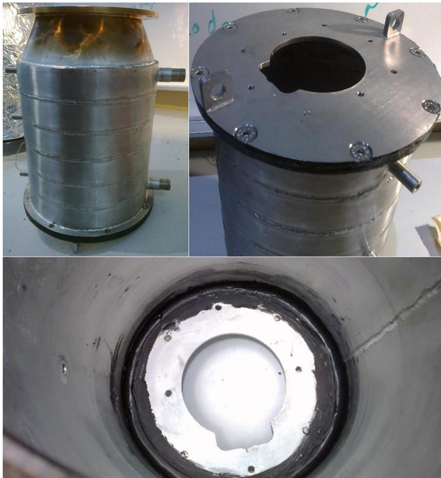
Figura 50 - Montagem da tampa traseira com o corpo de refrigeração
