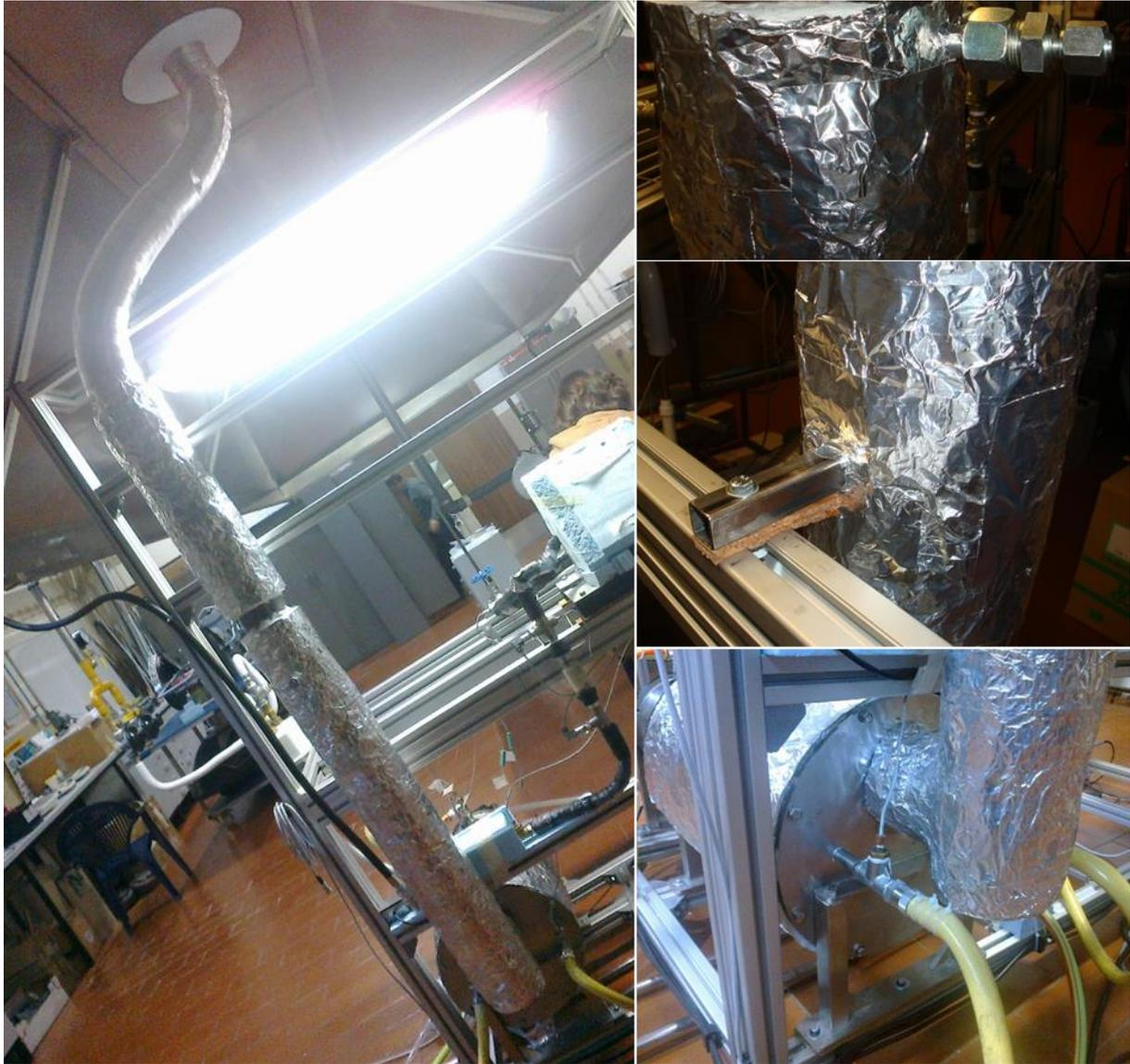
Figura 46 - Montagem da chaminé (com isolamento exterior) com a sonda e peças de fixação à câmara base
