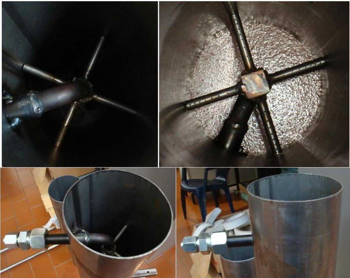
Figura 45 - Sonda de recolha dos gases para análise na sua posição final no interior na chaminé
