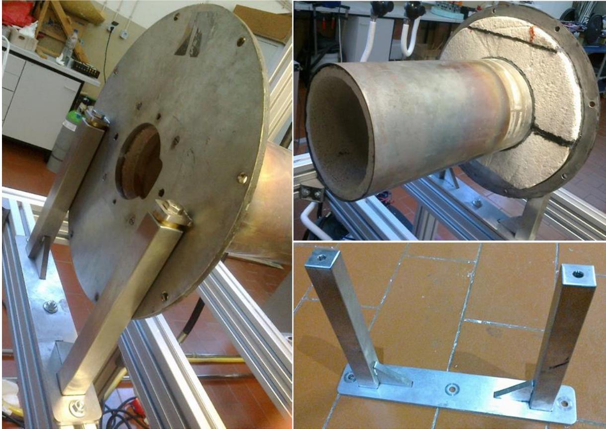
Figura 40 - Montagem da tampa frontal com o *inner cylinder* e o suporte
