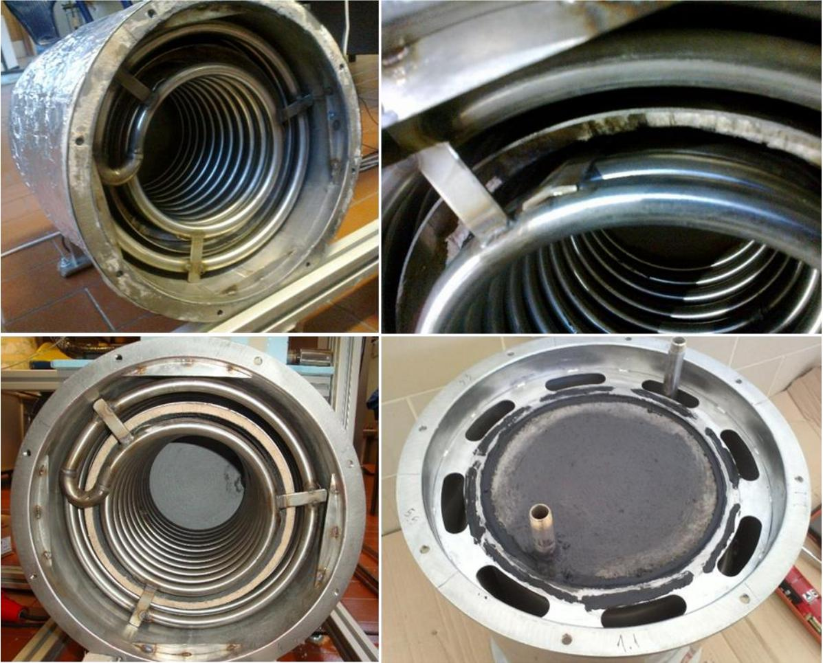
Figura 42 - Montagem do permutador de calor no corpo central
