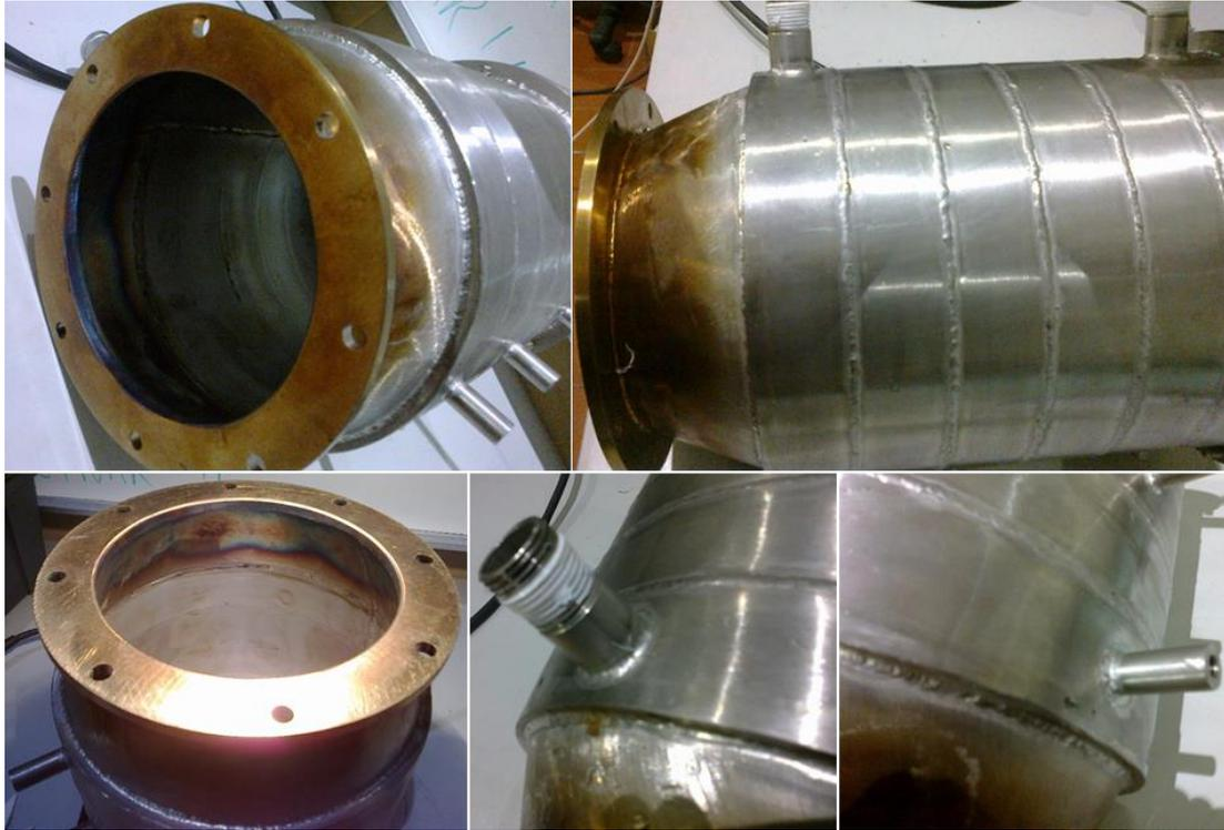
Figura 49 - Corpo exterior com camisa de refrigeração (já soldada)
