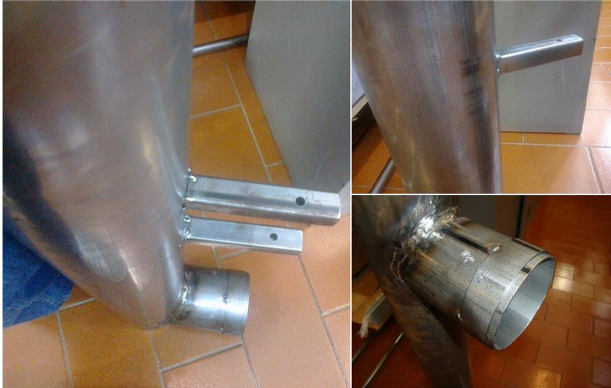
Figura 44 - Montagem da chaminé com peças de fixação (ligeiramente soldadas)
