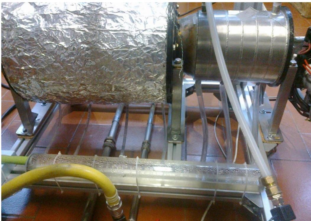
Figura 55 - Coletor para os condensados da configuração 1b
