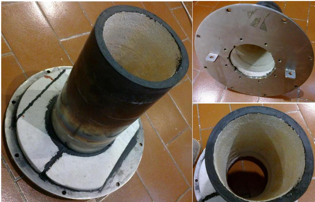
Figura 52 - Montagem da tampa da câmara de aquecimento com o *inner cylinder* 1b
