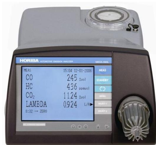
Figura 81 - Analisador de gases Horiba MEXA-584L
