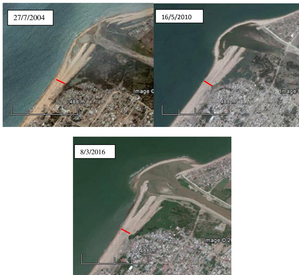
Figura 4.18- Imagens de satélite representando as diferentes posições que toma a desembocadura do Cavaco. O traço avermelhado indica o local do perfil.
