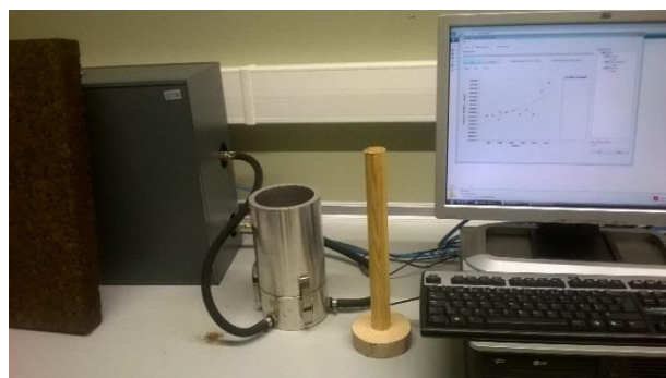
Figura 11 – Equipamento do ensaio da resistividade ao fluxo de ar.
