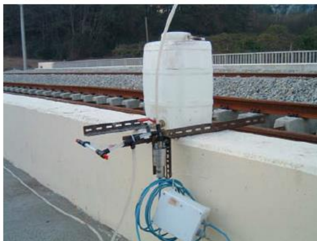
Figura 2. 11 - Sistema de nivelamento hidrostático, (Dimande, 2010).
