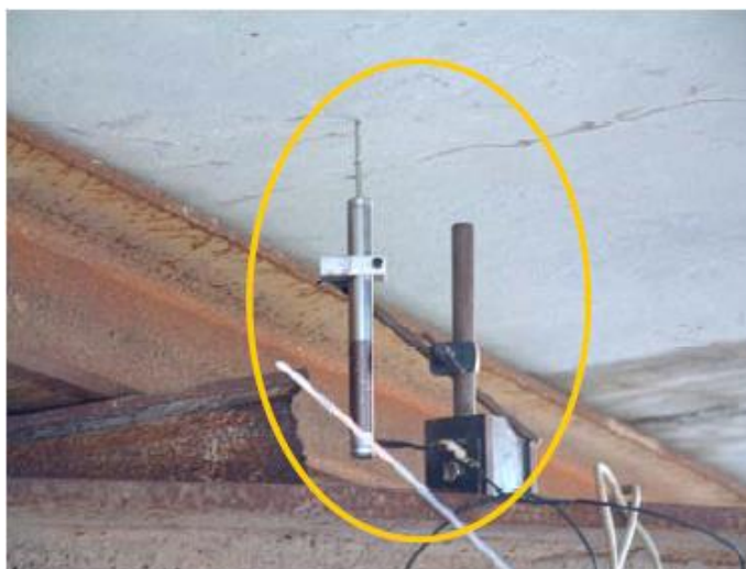
Figura 2. 10 - Pormenor de um transdutor LVDT, (Dimande, 2010).
