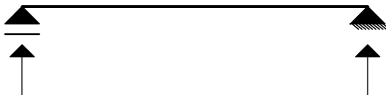
Figura 4.2 – Representação do modelo estrutural da chapa simplesmente apoiada
