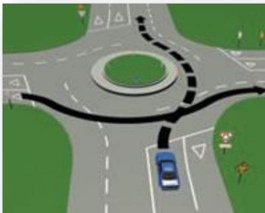
Figura 2.3 – Marcações no pavimento de rotundas Australianas e Neozelandesas (NZTA, 2015a)
