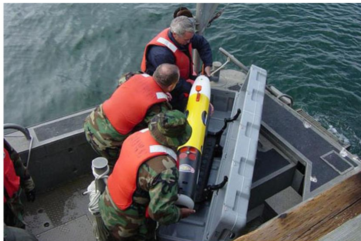
Figura 11 Lançamento do AUV REMUS 100 pela Marinha Norte Americana (Nicholson e Healey, 2008).
