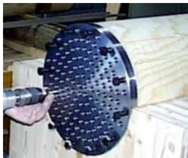
Figura 3.14 - Placa de encabeçamento tipo macho (Hamm e Schnuriger, 2002)
