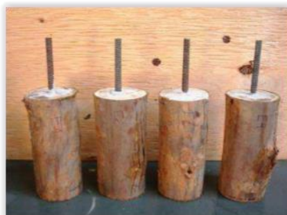
Figura 3.13 - Exemplos de ligações com varões colados (Calil et al 2003)
