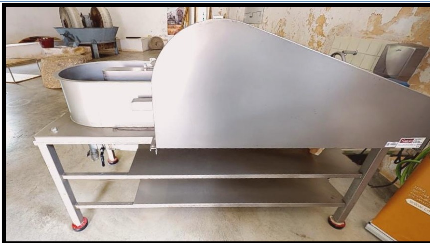
Tina Holandesa (executa moagem de papel através de energia elétrica)
