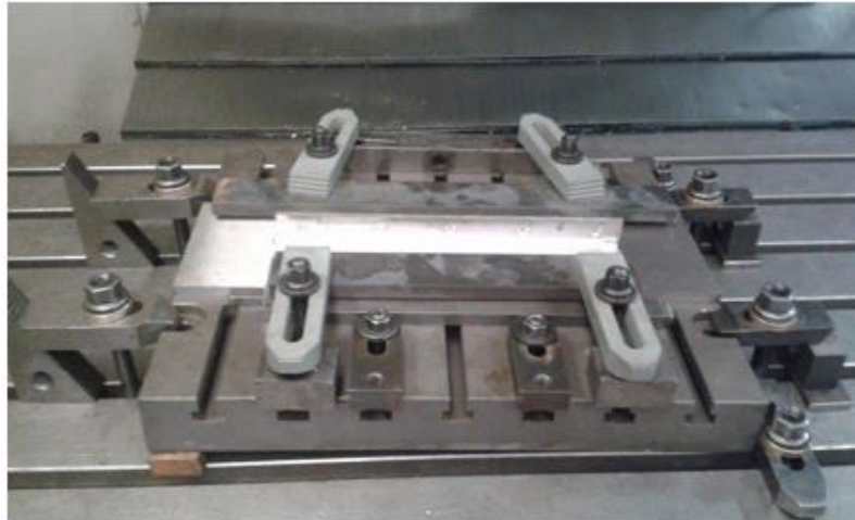
Figura 3.2. Sistema de fixação da placa na mesa.
