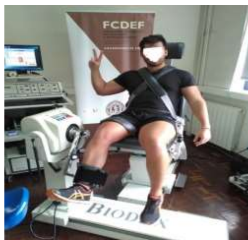
Fig 5. – Fixação dos sujeitos para os registos no dinamómetro Biodex Multijoint System 3 Pro .
