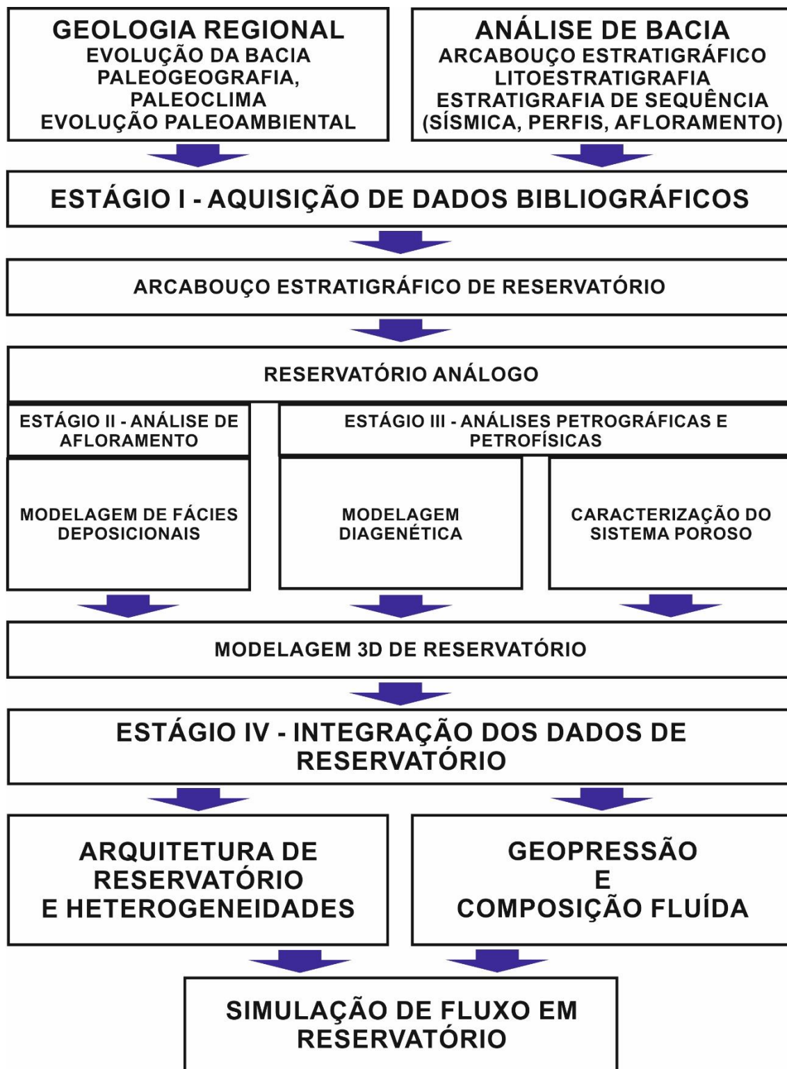
Figura 39 - Diagrama de fluxo ilustrando as atividades realizadas no desenvolvimento da Metodologia CAMURES aplicada em Afloramentos de Reservatórios Análogos (modificado de Huggenberg & Aigner, 1999; modificado de Garcia et al., 2003).
