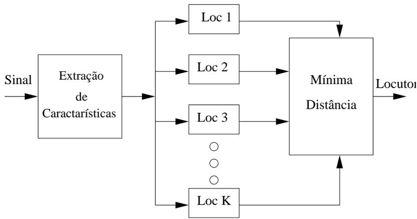
FIG. 4.1: Sistema de Identificação por Quantização Vetorial.
