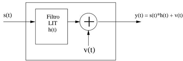
FIG. 9.2: Esquema de Canal com Filtro Linear
