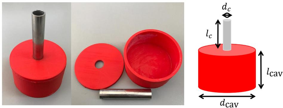
Figura 6.6.: Protótipo de ressoador acústico com cavidade em material de impressão 3D PLA e gargalo em aço inox.
