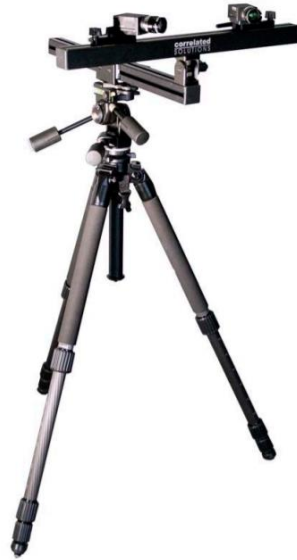
Figura 2.11. Montagem final do Vic-3D [33].
