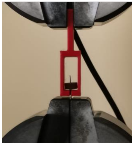
Figura 3.18 - Teste de tração adaptado para avaliação da adesão entre fio e matriz.
