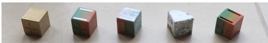
Figura 77 - Todos os processos a que os módulos foram sujeitos (Impressão, celagem em gesso, uniformização, limpeza, pintura).
