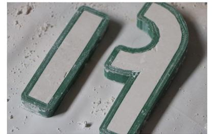
Figura 55 - Gesso após ser lixado nos moldes impressos.
