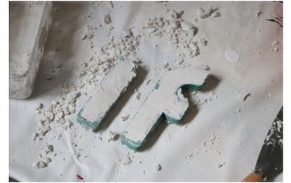
Figura 54 - Secagem do gesso nos moldes.
