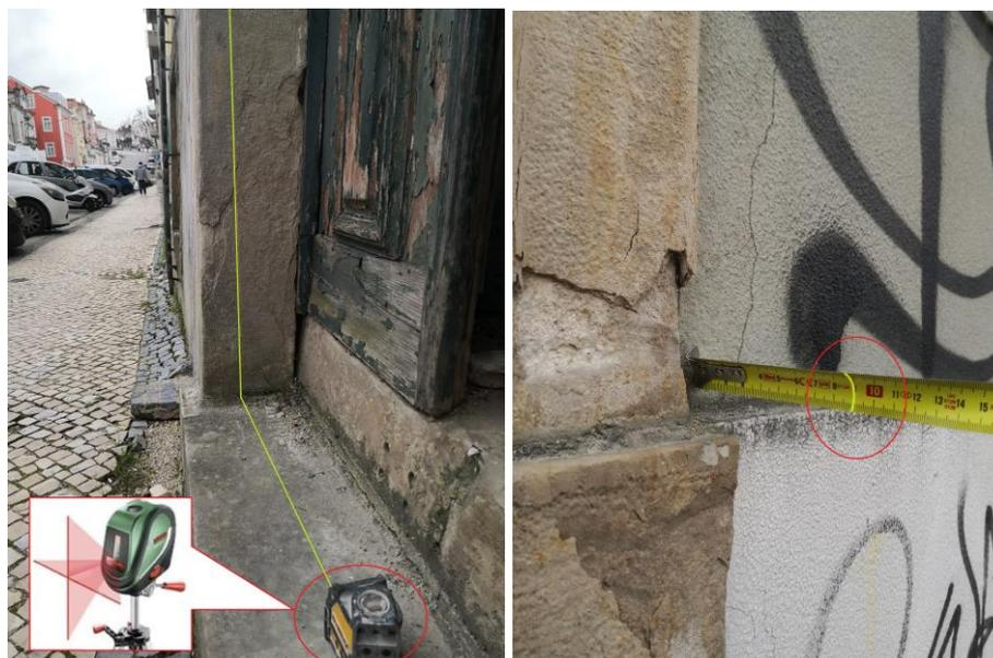
Figura 3.18 – Definição de plano vertical com Laser (esq.); Laser na fita métrica (dir.)
