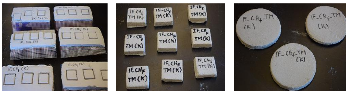
Figura 3.3 - Provetes de argamassas destacados dos suportes após cura
