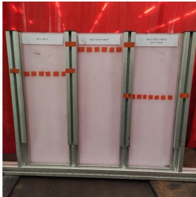
**Figura 4.8.** Protótipo do quadro *Kanban* com respetiva identificação de cada família.
